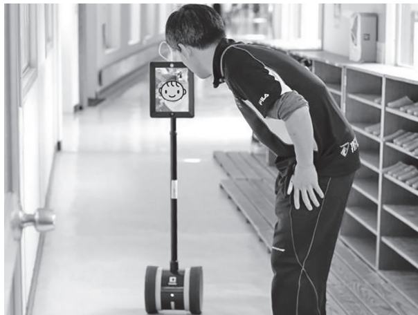
写真1：「Double Robotics社製の地上走行型ドローン」スマートフォンやPCからインターネット経由で操縦できる。
