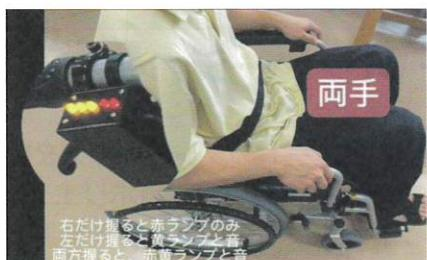
初心者が車いす移送介助の際に注意する点を学習できる車いすに取り外し可能な機器と学習方法のプログラムである。車いすを押してもらう乗車者が、急なスピード変化・坂や段差・曲がり角などで「怖い」と感じた時に機器付属スイッチを握りしめることで、声など出さずともその気持ちを後方の車いす介助者に音や光で伝えることができる機器を用いている。
