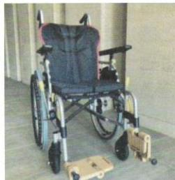
車椅子のフットサポートのプレート部分を左右で分割し、スプリングとPEライン（超高分子量ポリエチレン）を用いることで、フットサポートの開閉操作を容易にしました。
