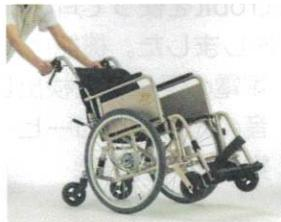
前輪キャスターを固定した6輪機構となっており、前輪を固定することで軽微な力で直進走行ができると共に、踏切横断の際にも溝にはまらず走行することが可能。また、ハンドルにわずかに荷重をかけることで、後輪での方向転換が実現。
